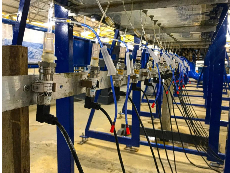
Figura 39 – Instalação dos transdutores no canal de ensaios
