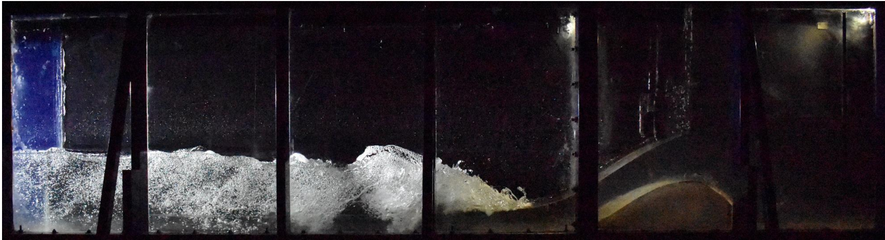
Figura 33 – Ressalto hidráulico: vazão de 100 l/s e Fr_1 = 2,3
