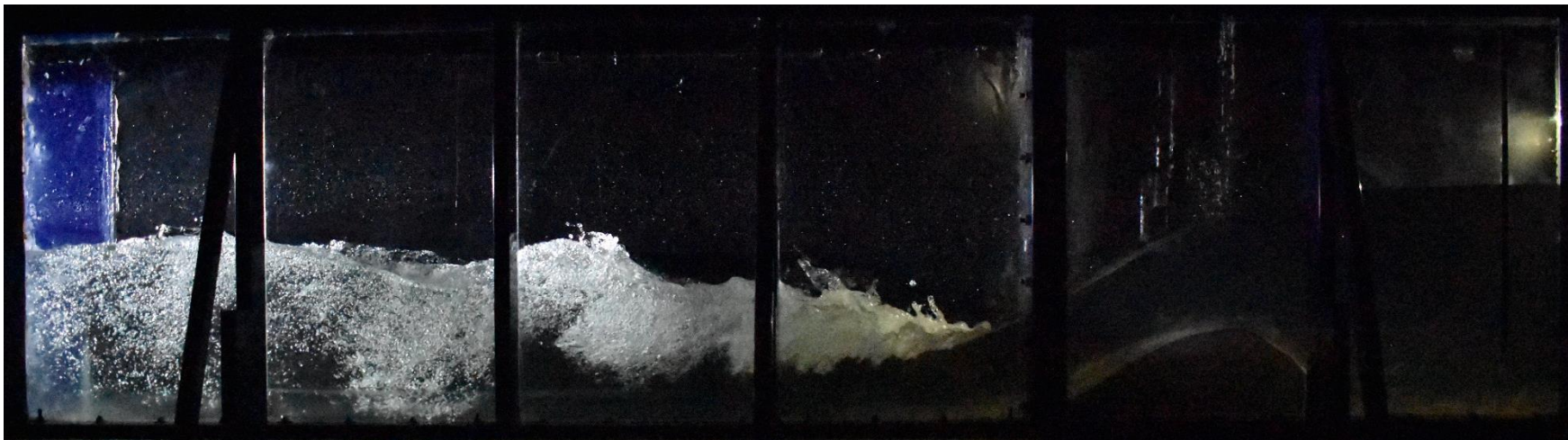
Figura 34 – Ressalto hidráulico: vazão de 150 l/s e Fr_1 = 1,9
