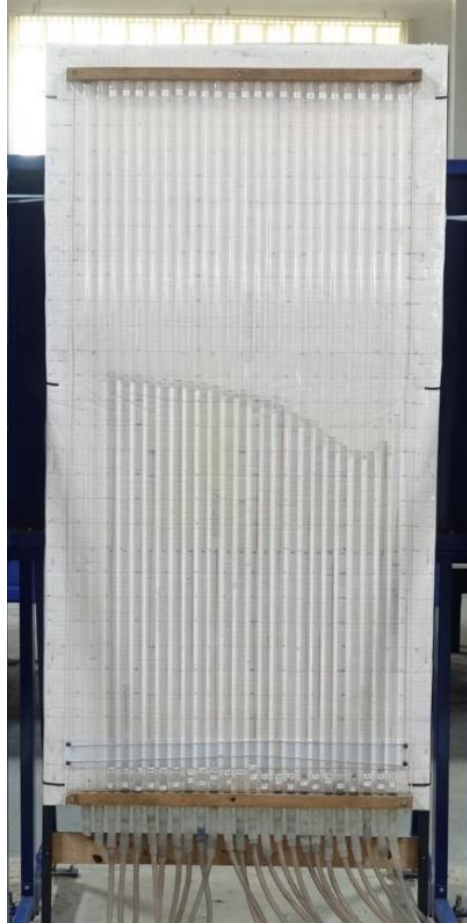
Figura 36 – Quadro de piezômetros. Vazão de 150 l/s e Fr_1 = 1,9
