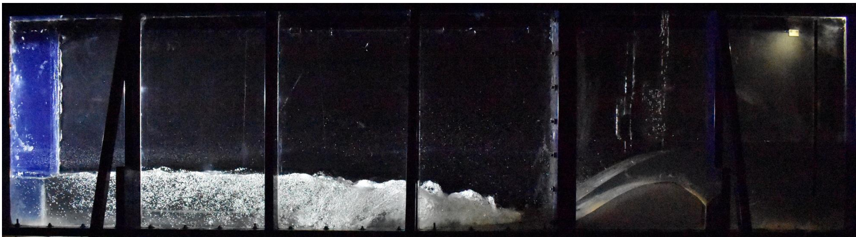
Figura 32 – Ressalto hidráulico: vazão de 50 l/s e Fr_1 = 3,0
