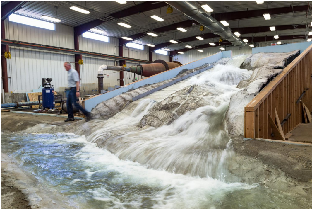
Figura 25 – Vertedouro da Barragem de Oroville, escala 1:50. Fonte: “Miniaturizing America’s Tallest Dam”, 2017
