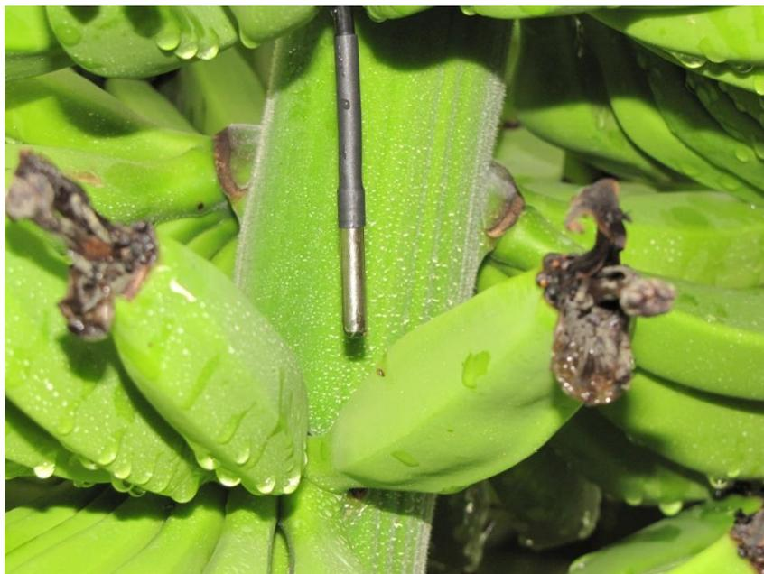
FIGURA 5. Posicionamento de sensor de temperatura, modelo PT-100 no interior de um cacho de bananas sob monitoramento de temperatura junto ao cacho de ensaio de ensacamento.
