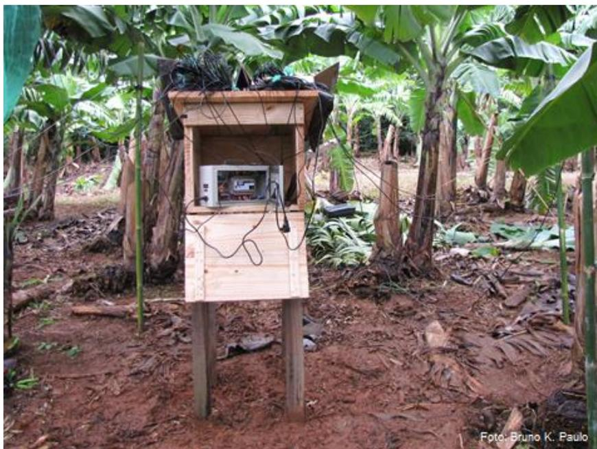
FIGURA 4. Estrutura de proteção do *datalogger* instalado na área experimental do bananal, em Torres/RS.
