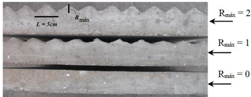
Figura 2.40 - Amostras das superfícies de concreto ensaiadas (adaptado de ZHAO et al., 2012).
