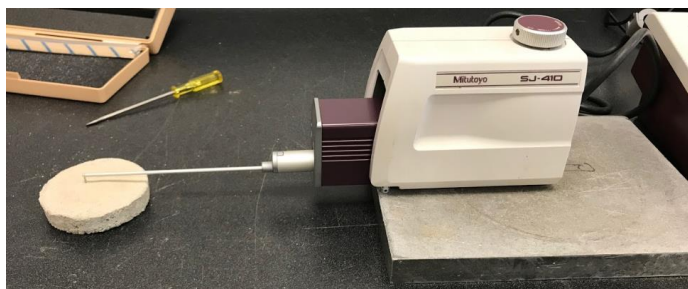
Figura 4.13 - Equipamento utilizado para obtenção dos perfis de rugosidade.
