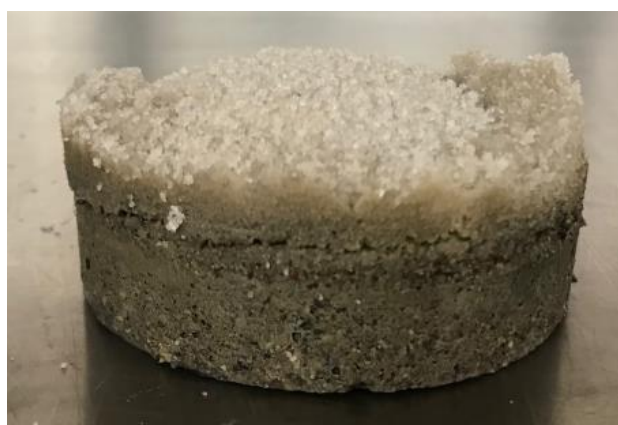
Figura 4.11 - Perfil da amostra, preparação para leituras da rugosidade.
