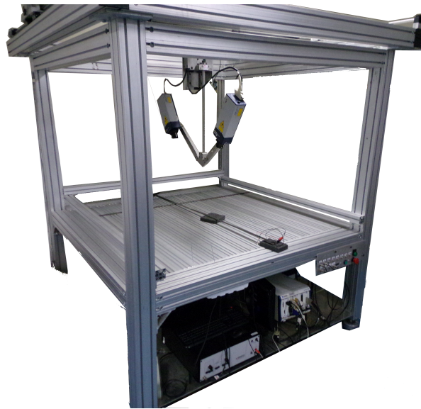
(a) Bancada utilizada para os ensaios no vibrômetro.
