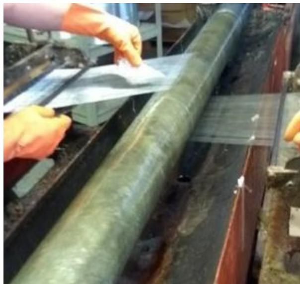
Figura 6: Etapa de produção da camada estrutural por Filament Winding .
