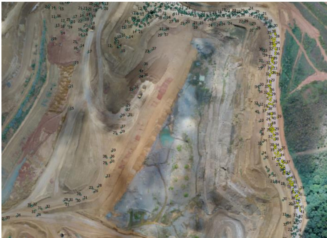
Figura 18 – Exemplo de registros do sistema de despacho plotados com a topografia de mina evidenciando suas velocidades instantâneas na sua localização.
