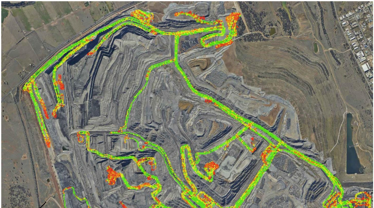
Figura 22 – Mapa de cores indicando qualidade das estradas, onde a escala de cores vai de verde (trechos adequados) até o vermelho (manutenção prioritária).
