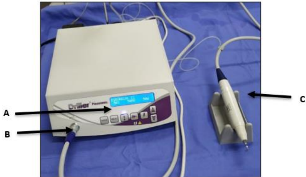
Figura 1: Instrumental cirúrgico piezoelétrico (Driller Piezosonic). A – Painel digital; B – Conector para inserção do cabo da peça de mão (caneta); C – Caneta com ponta ativa inserida.
