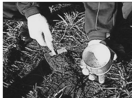
Figura 3 - Medição da umidade com TDR e retirada de amostra superficial.
