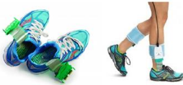
Figura 6 - Sistema para monitoramento da marcha humana baseado na acelerometria.
