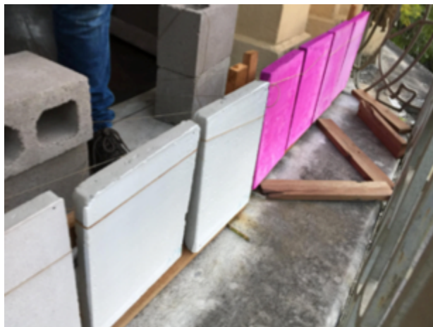
Figura 20 – Amostras de argamassas fixas na no suporte de madeira
