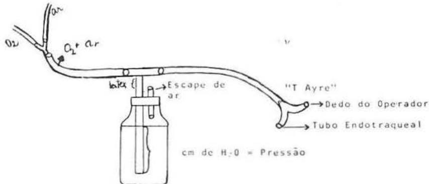
Fig. 1 — Sistema Gregory adaptado, permitindo o uso da concentração de O<sub>2</sub> e pressão desejada.
