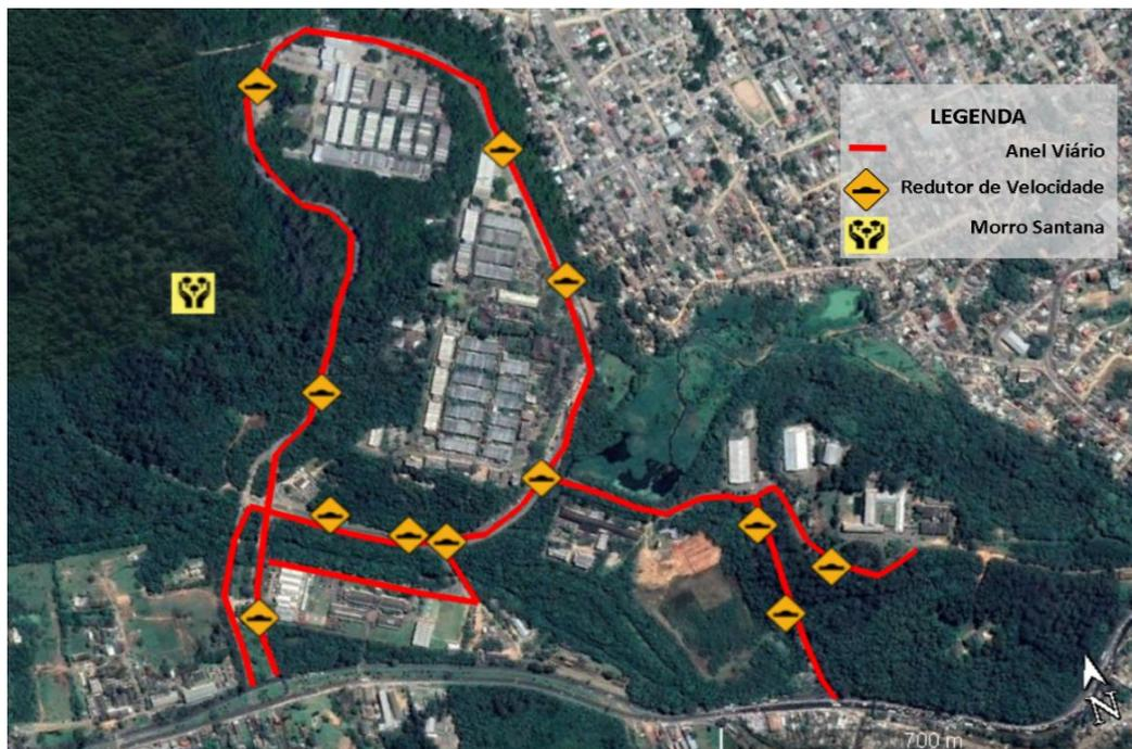
**Fig 1.** Imagem indicando o anel viário do Campus do Vale – UFRGS com a disposição dos redutores de velocidade e o Morro Santana (Fonte: adaptado no Google Earth).
