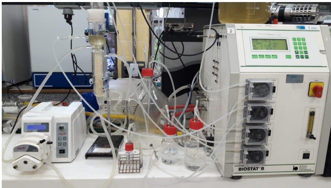
Figura 17: Biorreator de leito fluidizado montado com unidade de controle, bomba de recirculação e frascos de coleta e alimentação.
