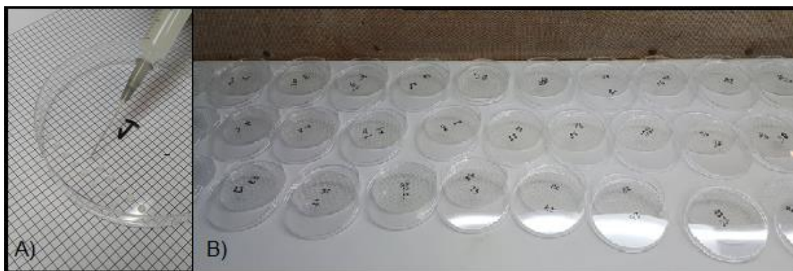
Figura 9: Etapas do processo de imobilização. A) Gotejamento em placa de Petri. B) Gelificação.
