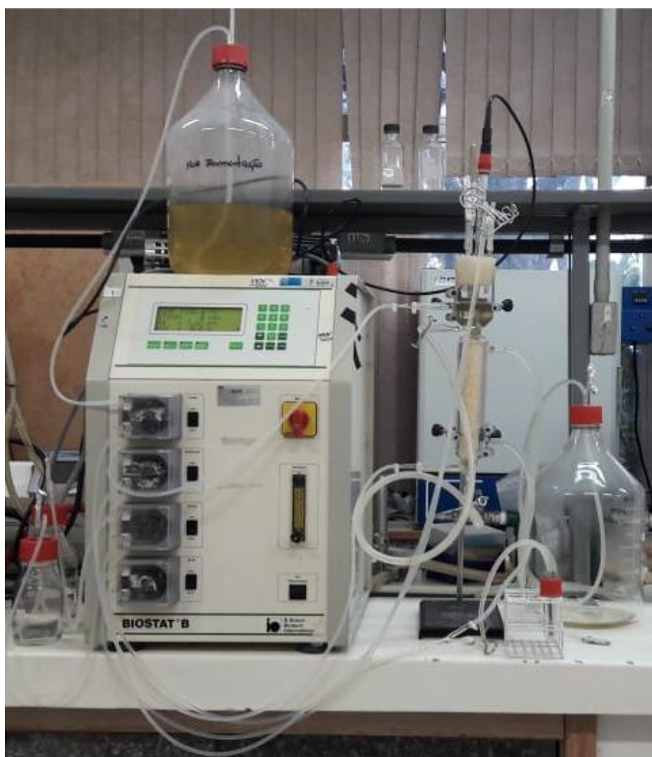
Figura 15: Biorreator de leito fixo montado com unidade de controle e frascos de coleta e alimentação.
