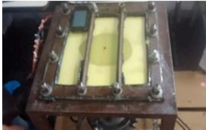
Figura 3.5 – Molde de RTM durante moldagem líquida de compósitos.
