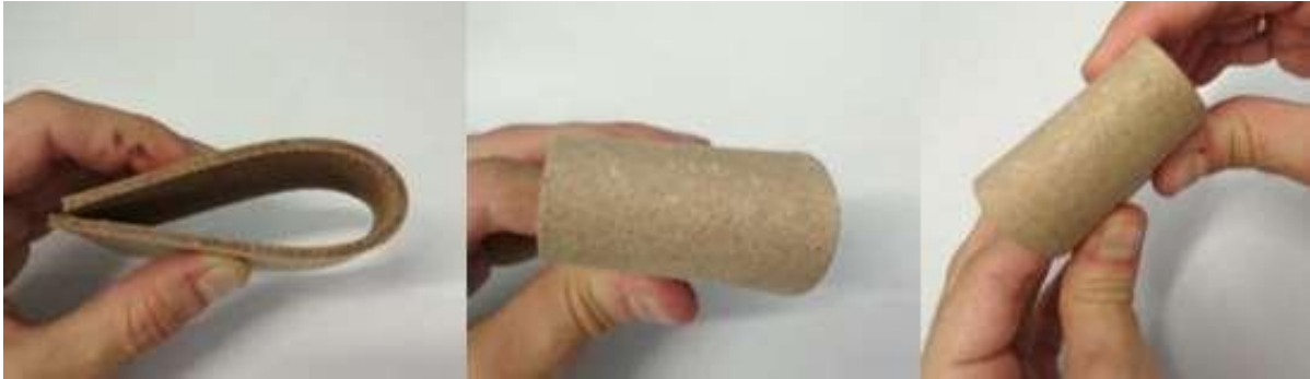
Figura 16 - Teste visual de quebra em dobra simples.
