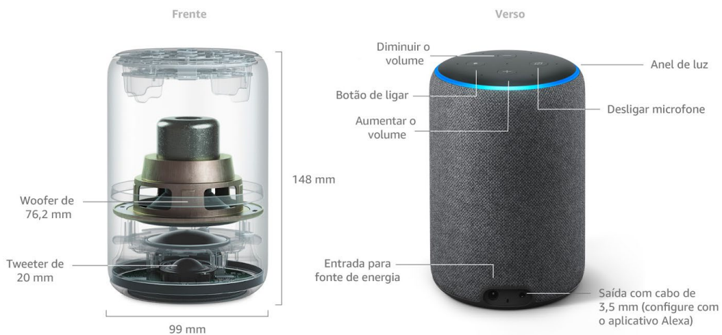
Figura 10 - Mecanismo interno do Echo
