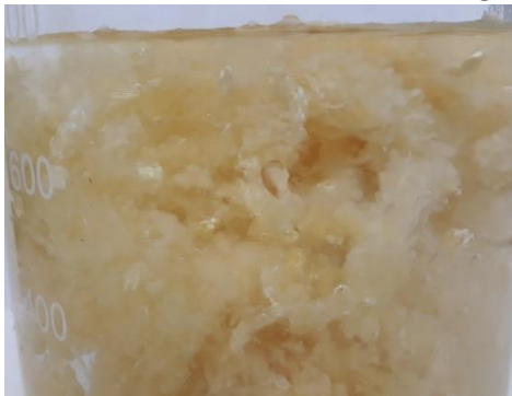
Figura 17. Paina tratada com NaOH em lavagem com água
