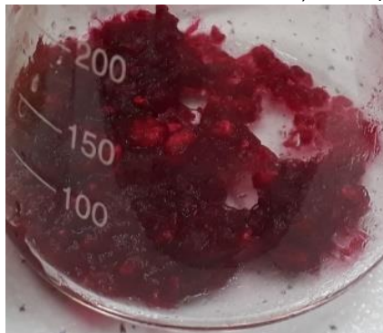
Figura 18. Paina modificada com NaOH a 0,1 mol/L após a adsorção.
