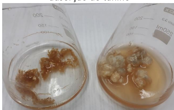
Figura 20. Paina tratada com NaOH a 5 mol/L antes (direita) e após (esquerda) a adsorção do tanino
