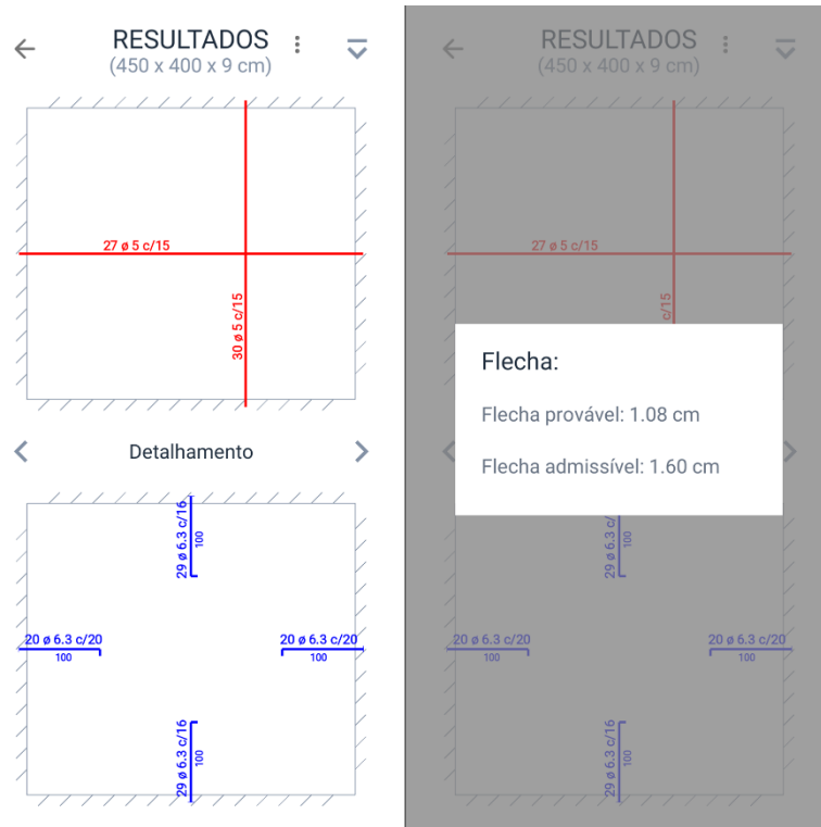
Figura 61 - Laje L2: detalhamento e flechas calculadas
