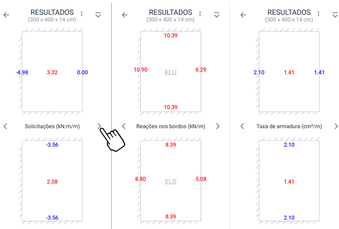
Figura 29 - Página de resultados das lajes: solicitações, reações nos bordos e taxas de armadura
