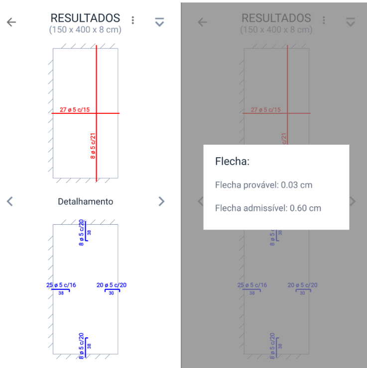
Figura 55 - Laje L3: detalhamento e flechas calculadas
