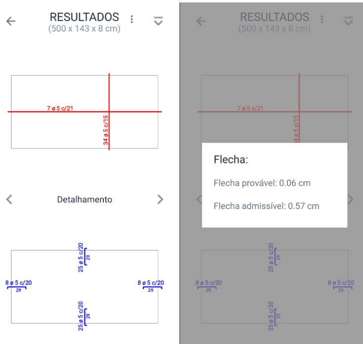
Figura 52 - Laje L6: detalhamento e flechas calculadas
