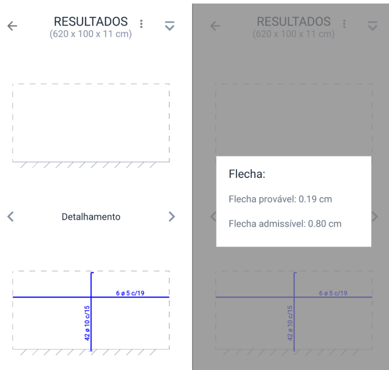
Figura 49 - Laje L5: detalhamento e flechas calculadas
