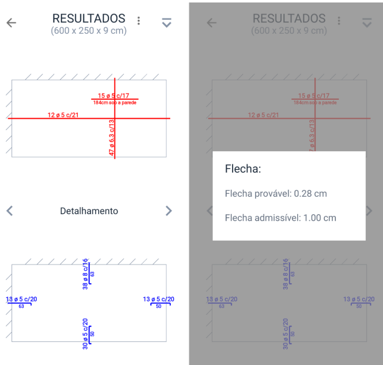
Figura 58 - Laje L4: detalhamento e flechas calculadas
