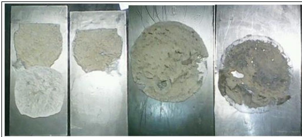
Figura 25 – Placas de metal com a amostra aderida (Fonte: autor, 2020).
