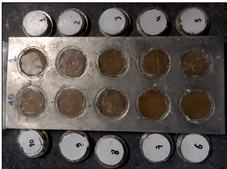
Figura 277 – Peças extraídas após a colagem da fita antiaderente e alteração do molde (Fonte: autor, 2020).
