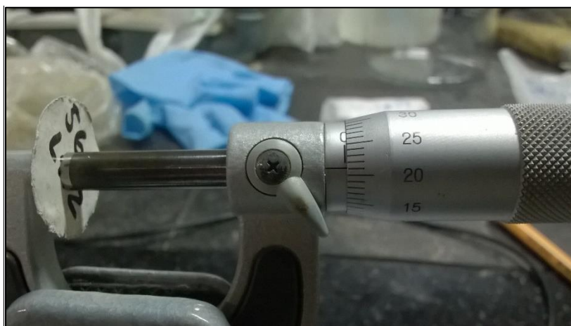
Figura 477 – Amostras sinterizadas com espessuras acima de 0,20mm e arestas onduladas na superfície (Fonte: Autor, 2020).
