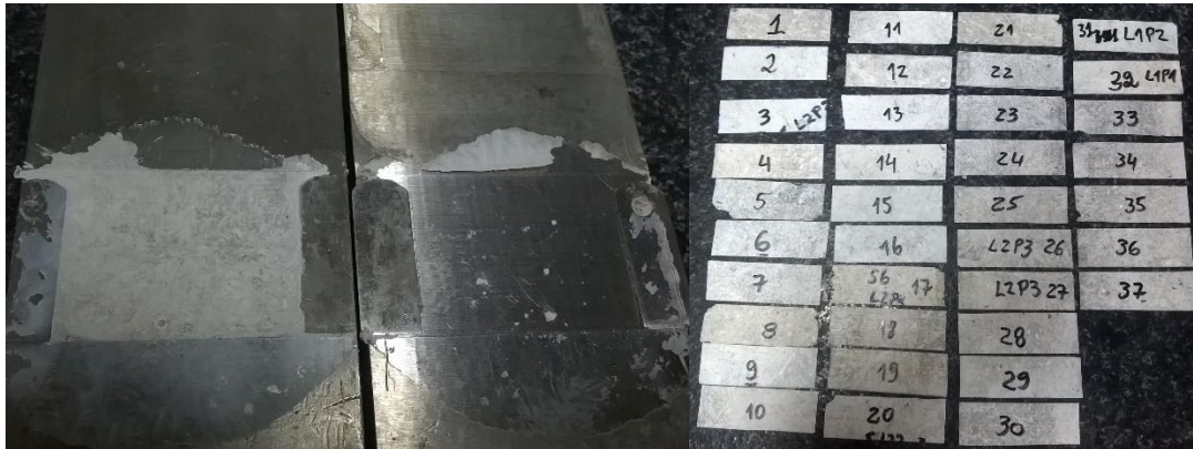
Figura 444 - Amostras conformada entre duas chapas metálicas sem furos e sem fita antiaderente.
