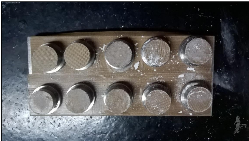
Figura 18 – Molde de aço SAE 1045 com fita antiaderente, (Fonte: Autor, 2020).
