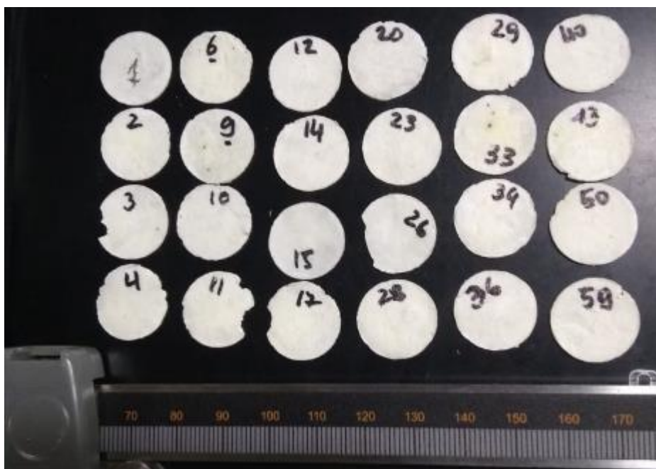
Figura 29 - Amostras conformadas usando a matriz com 10 cavidades após sinterização.
