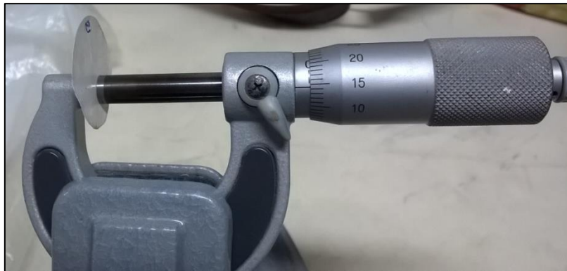
Figura 43 – Uso do micrômetro para demonstrar a espessura das amostras abaixo de 0,15mm (Fonte: autor, 2020).
