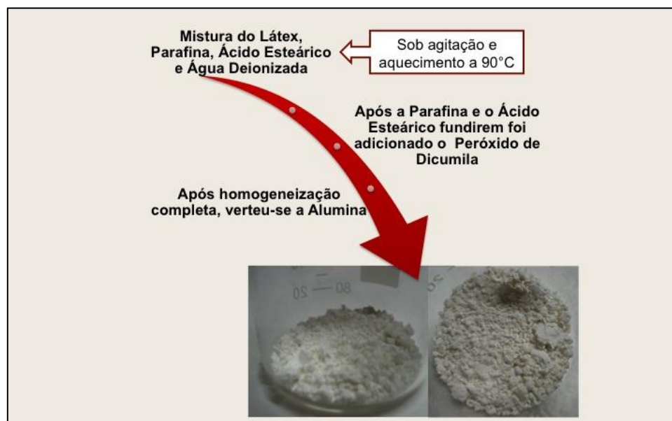
Figura 15 - Procedimento de mistura dos componentes, (Fonte: Autor, 2020).
