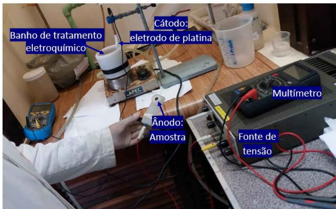
Figura 11. Sistema de tratamento eletroquímico utilizado nesse estudo.
