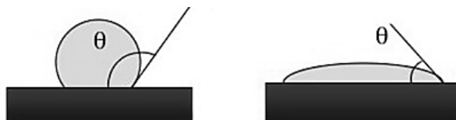
Figura 13. Diferenças no ângulo formado na superfície hidrofóbica (esquerda) e hidrofílica (direita).
