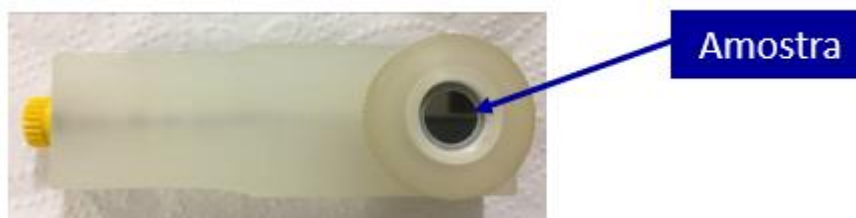
Figura 10. Suporte com a amostra a ser nanotexturizada.
