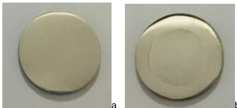
Figura 15. Amostras de Ti6Al4V (a) antes e (b) após o eletropolimento.
