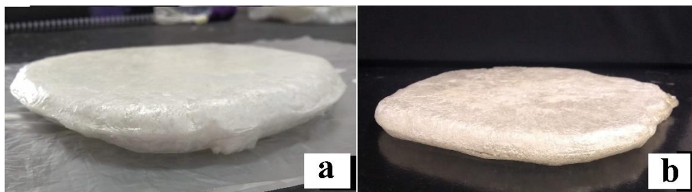
Figura 28: Espumas de fécula de mandioca modificada produzidas a partir da expansão das pastas obtidas pelas misturas diferentes: (a) espuma da mistura na batedeira (b) espuma da mistura na câmara interna.
