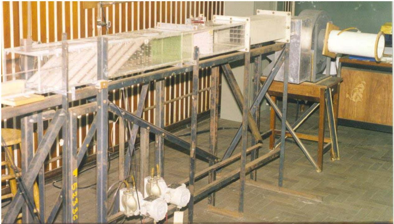
Figura 3.2 – Fotografia da bancada de testes montada com o banco de tubos com inclinação de  $30^\circ$ .
