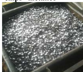
Figura 2: Resíduo “chips” metálico
