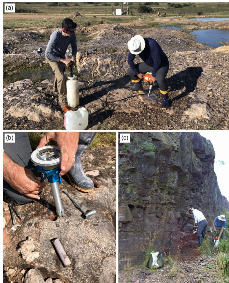
Figura 3. Metodologia de amostragem para coleta de dados paleomagnéticos: (a) e (c) amostragem com perfuratriz para obtenção dos cilindros, (b) processo de orientação dos cilindros amostrados.
