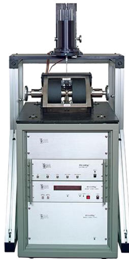
Figura 7. Magnetômetro MicroMag 3900 utilizado para aquisição das curvas de histerese, MRI e diagramas FORC. Extraído do site da fabricante do equipamento (Lake Shore Cryotronics).
