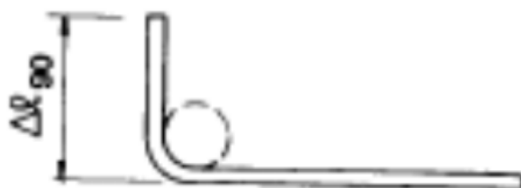
Figura 16: Comprimento do gancho ancoragem. (Figura VII-5 de Bessa (2017)).
