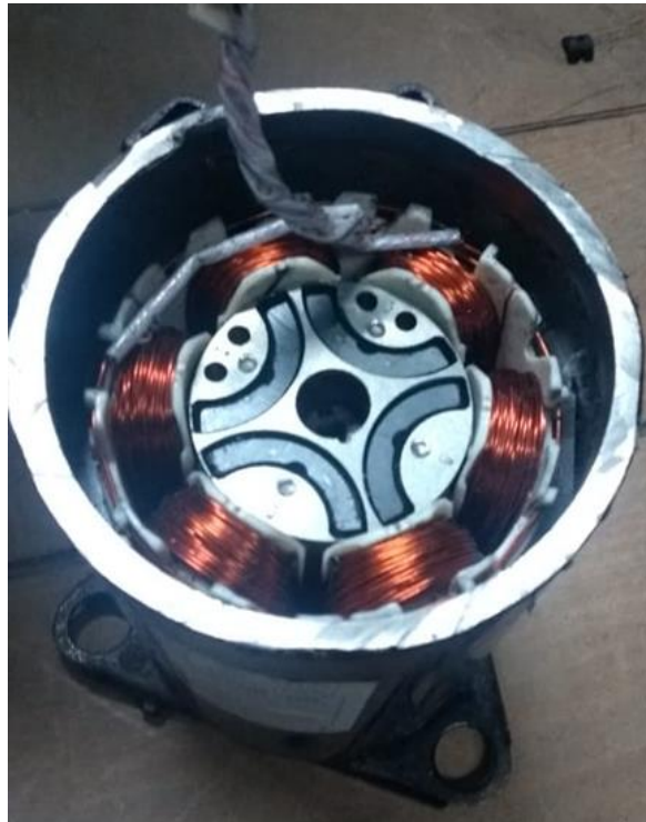
Figura 33: Motor do compressor de condicionador de ar com tecnologia inverter
