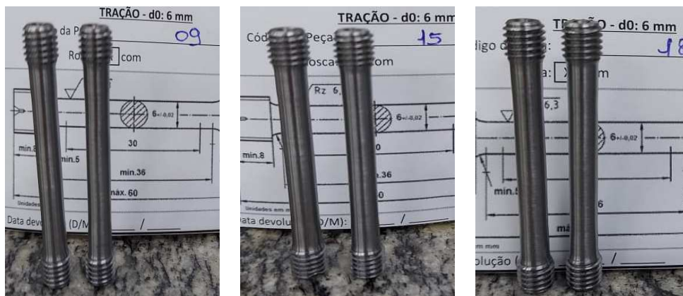
Figura 21. Corpos de prova para ensaio de tração. Da esquerda para direita: Peça 09, 15 e 18. Fonte: autor.
