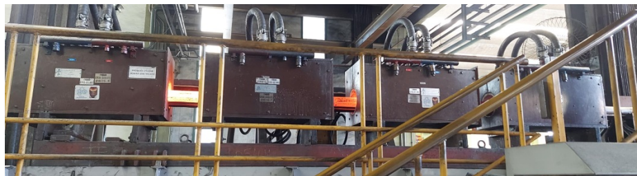
Figura 10. Forno indutivo utilizado para aquecimento dos blanks. Fonte: autor
