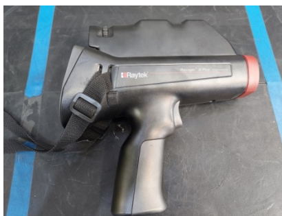
Figura 13. Pirômetro com capacidade de leitura no intervalo de 400 - 2000°C. Fonte: autor.
