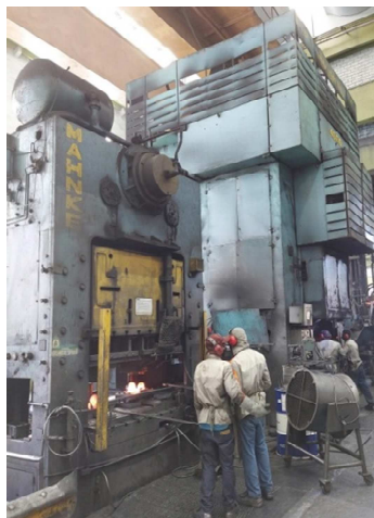
Figura 11. Prensa de forjamento e rebarbação. Fonte: autor.
