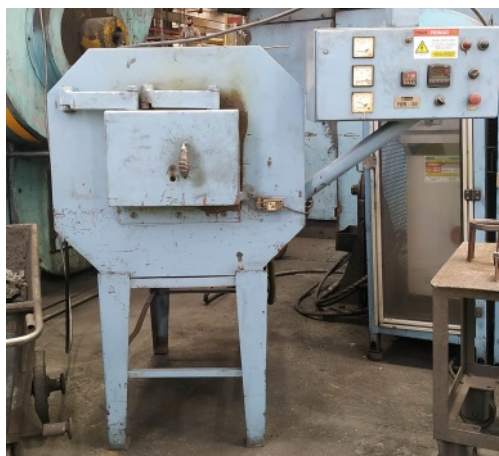
Figura 12. Forno da marca Brasimet, 15kW de potência. Fonte: autor.
