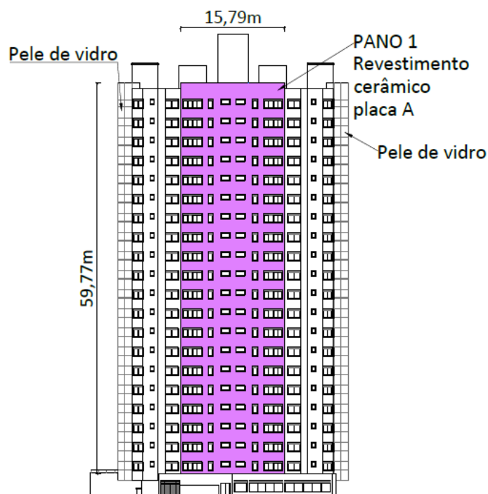
Figura 53 - Indicação do maior pano de fachada, com suas dimensões
