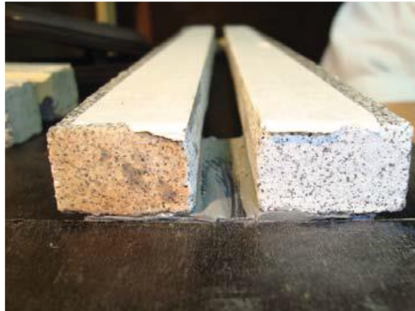
Figura 38 - Proteção das bordas da junta com fita adesiva
