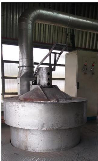
Figura 3.5 Forno de Convecção para a realização do tratamento térmico de Revenimento.
