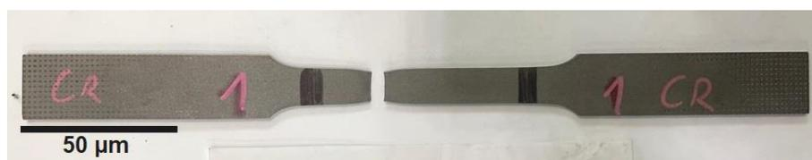
Figura 4.8 CP após a realização do ensaio de tração.
