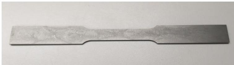
Figura 3.7 CP confeccionado para ensaio de tração.
