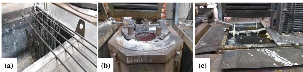
Figura 3.3 (a) Forno resistivo para pré-aquecimento; (b) Banho de sal para aquecimento/austenitização; (c) Banho de sal para o resfriamento 1.
