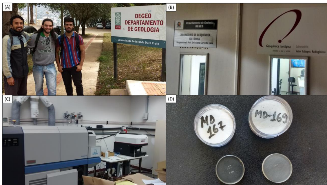
Figura 39 – Departamento de análise isotópica da IGL-UFOP em (A) e (B). Em (C) equipamento de ICP-MS Thermo Scientific Element 2 . Em (D) as pastilhas que contêm os zircões analisados.
