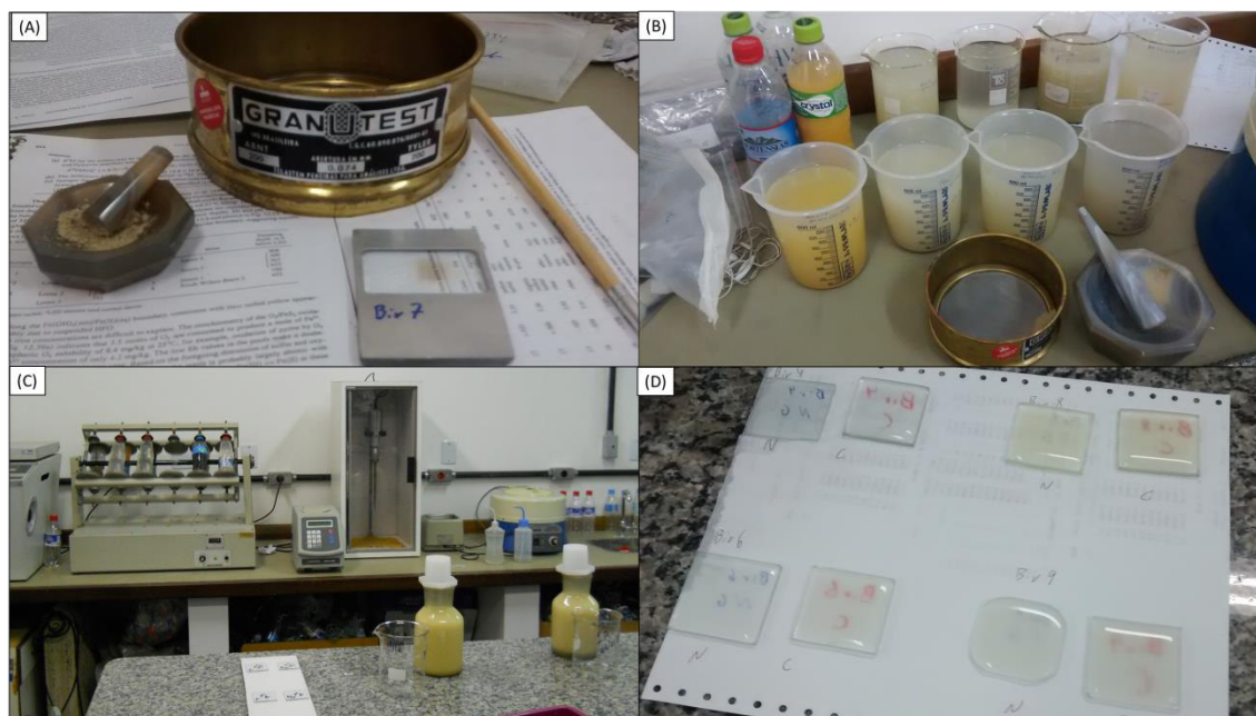
Figura 25 – Processo de preparação de amostras desorientada e orientada em DRX. Em (A) é indicada a etapa de preparação de amostra de rocha total para uma análise desorientada. Em (B) a preparação das amostras para análise orientada. Em (C) são expostas, em primeiro plano, as amostras em solução. Na bancada junto à parede aparece à direita o equipamento de ultrassom de ponteira e à esquerda o orbitador. Na imagem (D) a fração argila é depositada na lâmina de vidro que após serão submetidas ao DRX para obtenção dos difratogramas.
