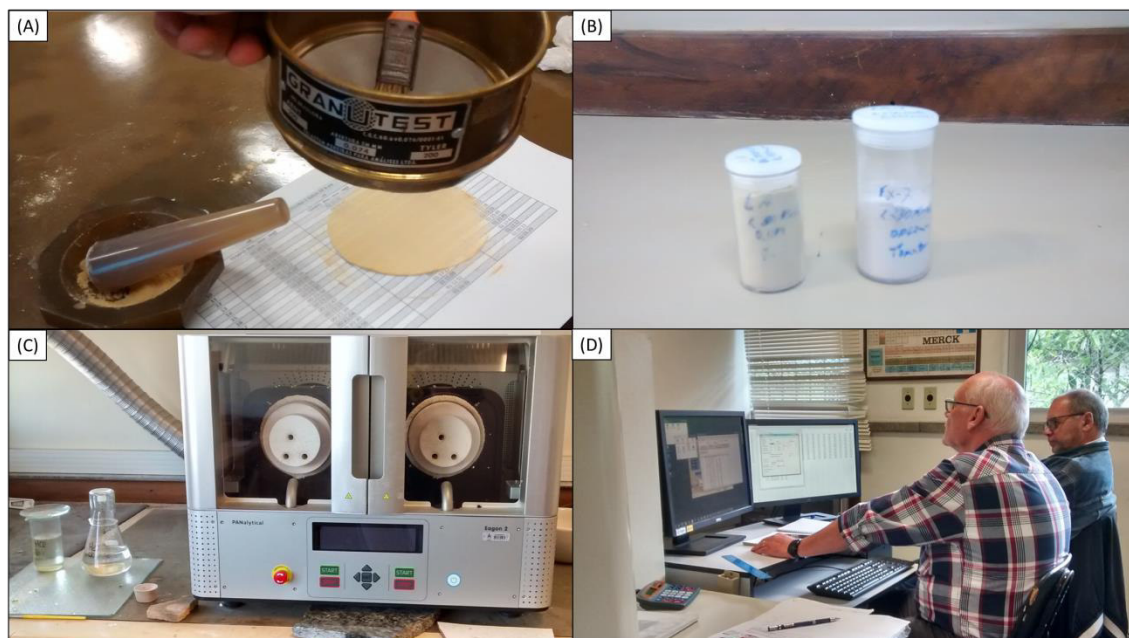
Figura 29 – Processo de preparação de amostras para FRX. Em (A) é mostrado o processo de peneiramento para análise química e em (B) a amostra pulverizada para a confecção de pastilha prensada e fundida. Em C, o forno para a confecção das pastilhas fundidas. Em (D) o espectrômetro de fluorescência de Raios-X Rigaku RIX2000 em processo de análise.
