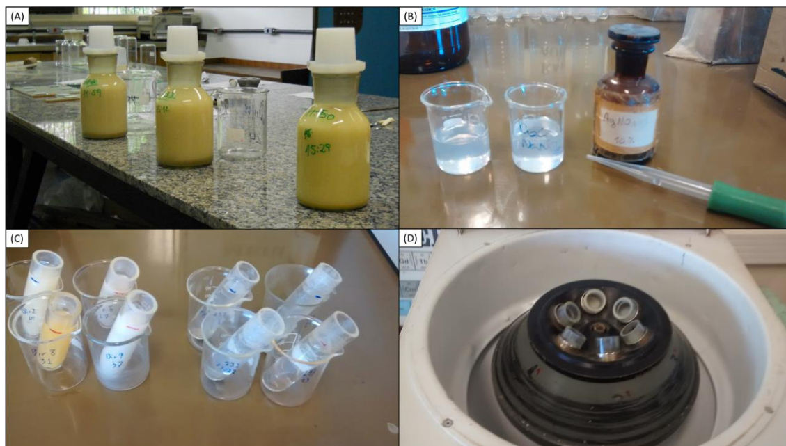
Figura 26 – Processo de saturação das amostras para análise em DRX. Em (A) são reveladas as amostras em solução. Em (B) é mostrado o momento do teste com \text{AgNO}_3 . Em (C), são indicadas as amostras no tubo usado na centrifugação e em (D) são expostos os tubos no centrifugador.
