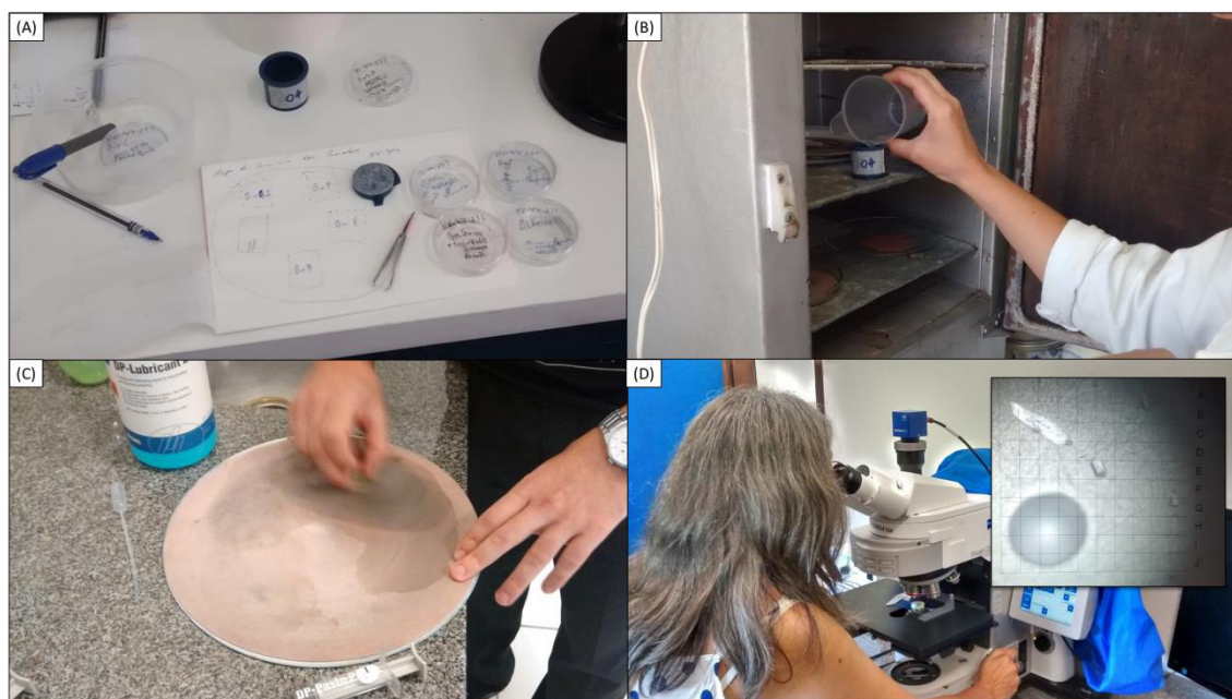
Figura 37- Processo de preparo de pastilha para datação em LA-MC-ICPMS. Em (A) apresenta o mapa das localizações dos agrupamentos dos níveis de PFDs. Em (B) mostra o momento de preenchimento por resina epóxi do disco sobre a lâmina. Em (C) revela o polimento da pastilha e em (D) a checagem das exposições dos zircões.
