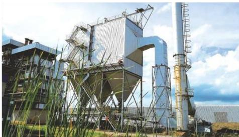
Imagem 06: Precipitador Eletrostático (fonte: <http://sugar-asia.com/sustaining-reliability-of-electrostatic-precipitator-esp-starts-with-proper-actions/>)
