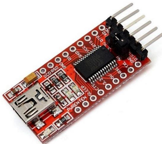
**Figura 7:** Exemplo de conversor USB-serial para fazer *debugging* do software executando no sistema embarcado [37, 38].
