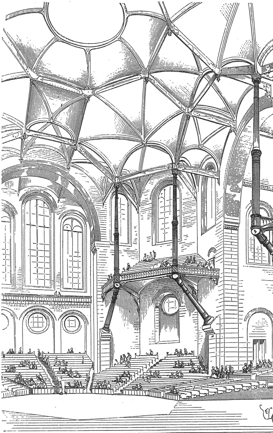
FIG. 41 ▼ Ilustração da prótese em vista lateral. Fonte: Autor. FIG. 41' ▲ Sala para concerto com quarenta e seis metros de vão livre. Fonte: Viol- let-le-Duc, 1872.
