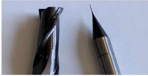
Figura 6: Fresa de topo reto de 6 mm de diâmetro (à esquerda) e microfresa de 200  $\mu\text{m}$  (à direita) (Bissacco et al., 2005).
