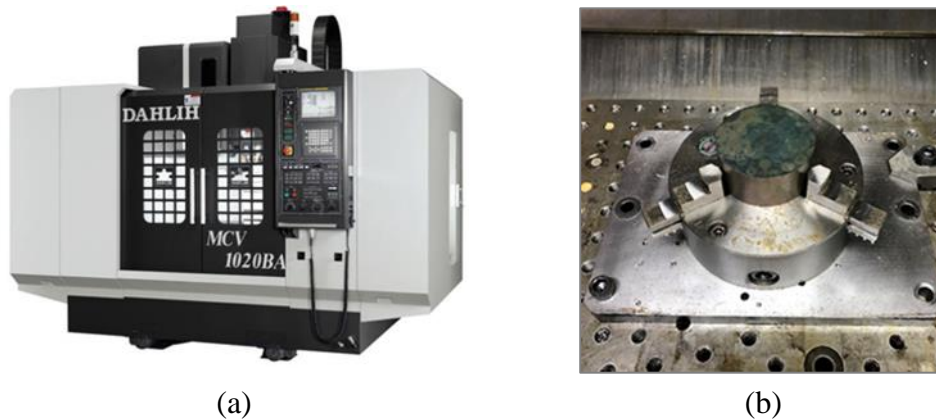
Figura 6 – (a) Imagem do centro de usinagem; (b) fixação da peça na mesa.
