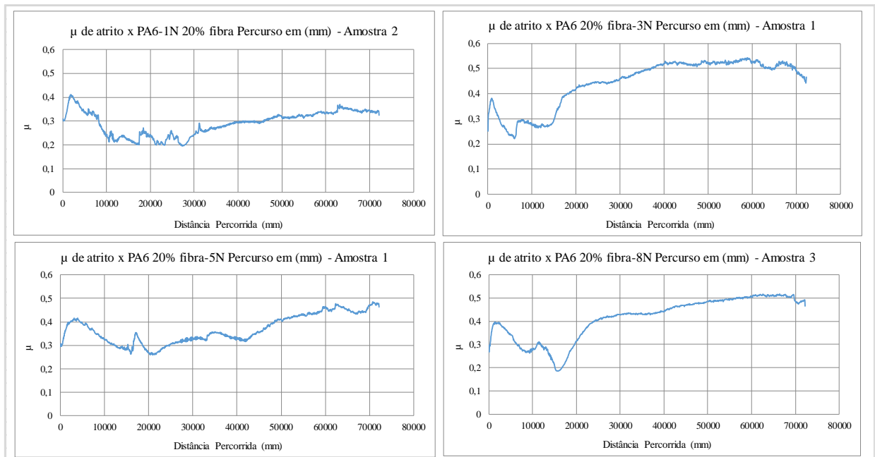
Figura 39 – Coeficiente de atrito ( \mu ) das amostras avaliadas com carga de 1, 3, 5 e 8N para o material PA6 20% fibra de vidro.
