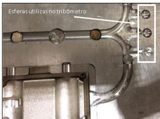
Figura 31 – Molde utilizado para injeção das esferas dos polímeros utilizadas no ensaio de desgaste ball-on-plate .
