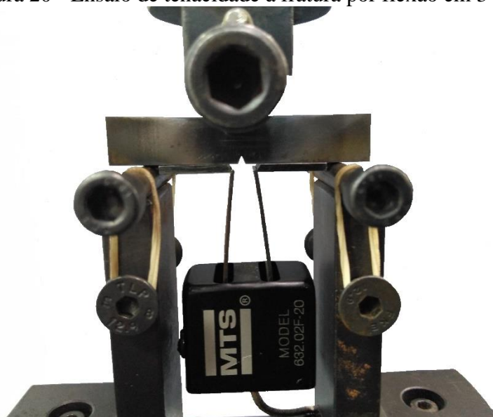
Figura 20 - Ensaio de tenacidade à fratura por flexão em 3 pontos.
