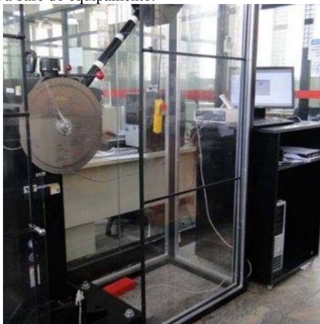
Figura 23 - (a) Visão geral do equipamento para ensaio de Charpy instrumentado; (b) Visão próxima a base do equipamento.
