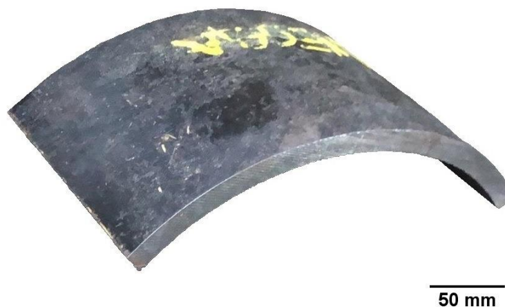
Figura 10 - Trecho de tubo Q125
