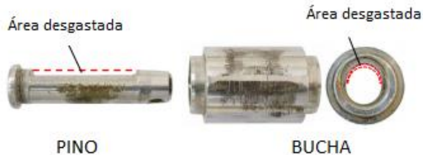
Figura 6 - Pino e bucha após o ensaio de desgaste na máquina tradicional (adaptado de Saito et al.,2020)
