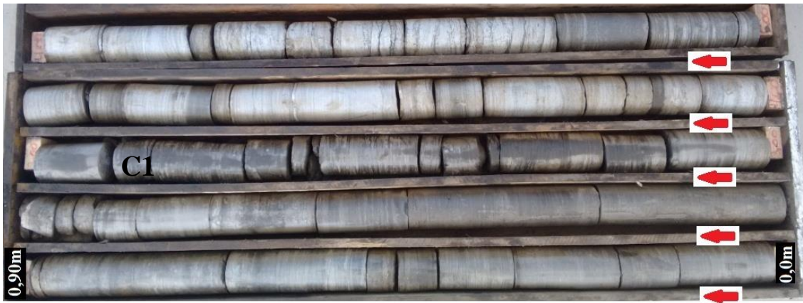
Figura 45 - Fotografia de testemunhos de sondagem (FT – 2): R, início da coluna de resina; P, ancoragem final do tirante; C1, contato entre as unidades 1 e 2.
