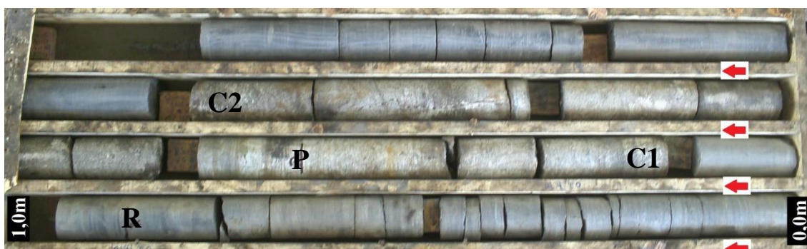
Figura 39 - Fotografia de testemunhos de sondagem: (R), início da coluna de resina; (P), ancoragem final do tirante; (C1), contato entre as unidades 1 e 2; (C2), contato entre as unidades 2 e 3.
