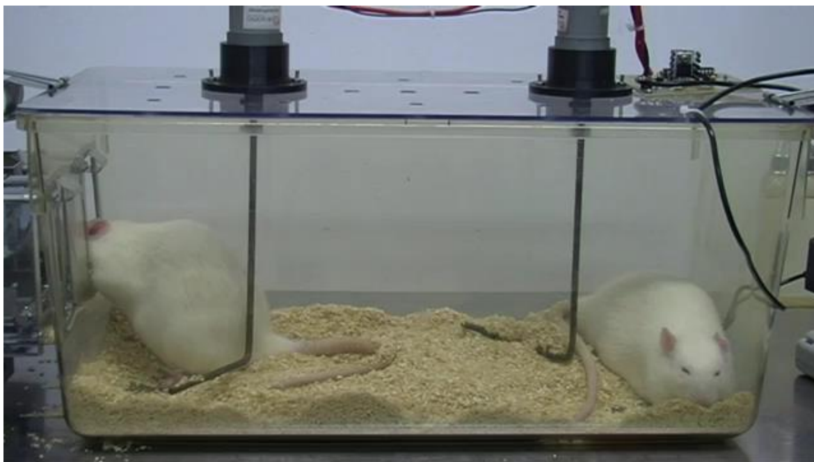
Figura B. Aparato para protocolo de privação de sono em ratos Wistar. O sistema consiste em um microcontrolador que executa o controle de 2 motores de passo responsáveis pela movimentação de duas hastes em forma de L. Essas hastes de metal giram em uma velocidade programável. Suas movimentações descrevem circunferências adjacentes que cobrem quase todo o alojamento dos animais. A comida e a bebida são acopladas pelos lados da caixa, de modo a permitir alimentação e água ad libitum mesmo durante a privação de sono. Os animais podem permanecer na caixa mesmo durante o repouso, não sendo necessária a troca de ambiente. Recurso audiovisual disponível em “Tonon AC et al. FeSBE 2019 - Demonstration of sleep deprivation model in Wistar rats”, pelo link: https://www.youtube.com/watch?v=o39yWw7Uw5g .
