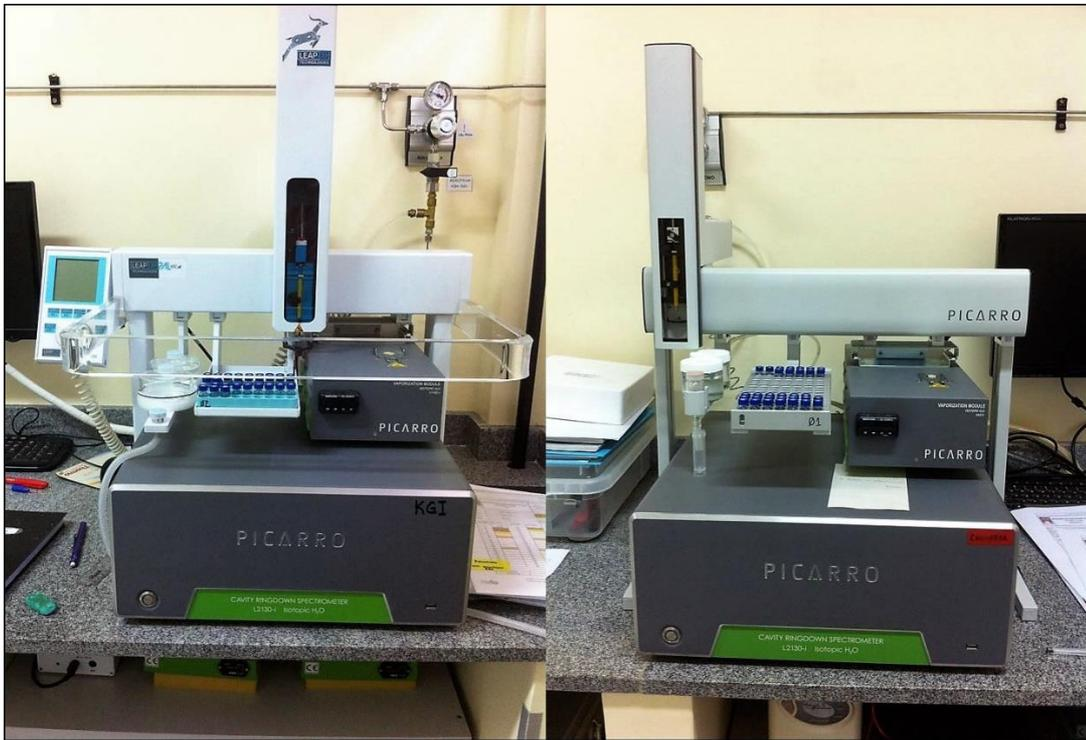
**Figura 13** - Espectrômetros a laser de cavidade ressonante do tipo ring-down (WS-CRDS - *Wavelength-Scanned Cavity Ring Down Spectroscopy*, sistema Picarro) utilizados na determinação das razões de isótopos estáveis (Laboratório de Glacioquímica do Centro Polar e Climático/ UFRGS).
