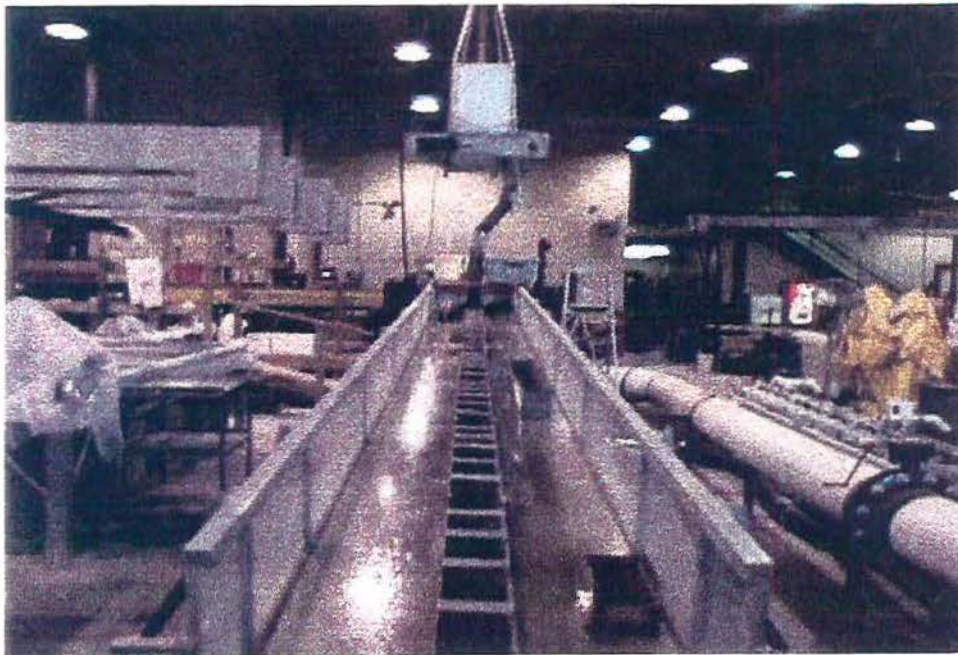
Figura 4.11 Sequência de caixas e conjunto silo distribuidor de sedimentos montadas sobre um canal de declividade variável.
