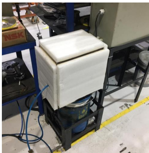
Figura 6 – Gabinete acústico instalado no equipamento
