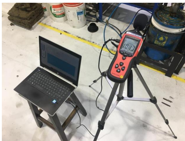
Figura 2 – Decibelímetro DEC-490 Instrutherm
