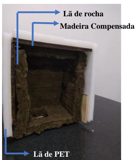
Figura 7 – Gabinete acústico em perspectiva
