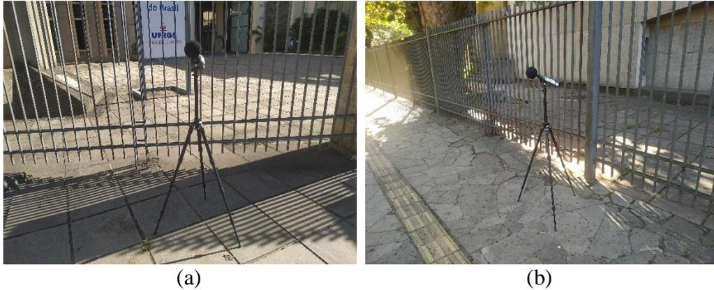
As vias são caracterizadas como coletoras, uma vez que a velocidade de trânsito dos veículos é de 40 km/h. O sonômetro foi posicionado a 3,0 m e a 4,0 m da via, respectivamente. O tempo de medição foi de 15 minutos para o ponto 3 e de 10 minutos para o ponto 4.
