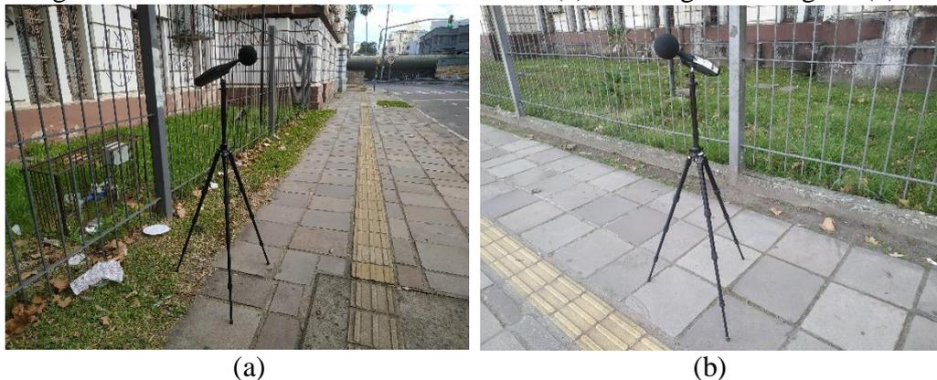
As vias são caracterizadas como coletoras, uma vez que a velocidade de trânsito dos veículos é de 40 km/h. O sonômetro foi posicionado a 2,8 m e a 3,5 m da via, respectivamente. O tempo de medição foi de 15 minutos em ambos os pontos.
