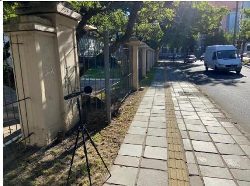
A via é caracterizada como arterial, uma vez que a velocidade de trânsito dos veículos é acima de 50 km/h. O sonômetro foi posicionado a 4,0 m da via. O tempo de medição foi de 10 minutos.
