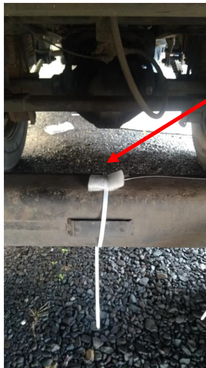
Figura A.5 – Local de instalação de um dos acelerômetros. (Fonte: Próprio autor)
