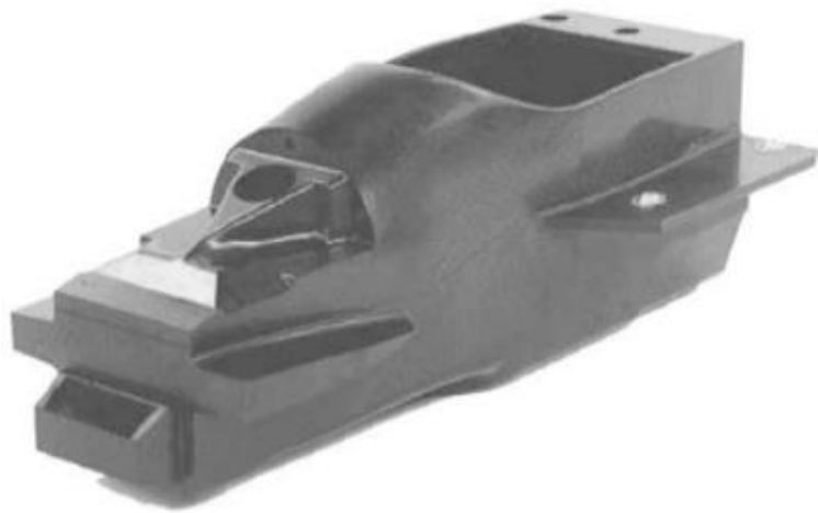
Figura 2 – Representação de um chassi monocoque. Fonte: Seward (2015)
