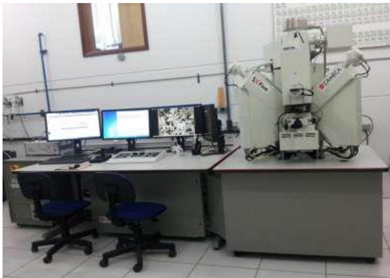
Fig. 7: Microsonda Cameca SXFive do Laboratório de Microsonda Eletrônica, IGEO-UFRGS.
