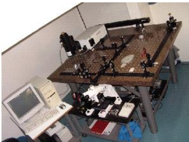
Fig. 8: espectrômetro Raman do Laboratório de Microanálise do Instituto de Física da UFRGS.
