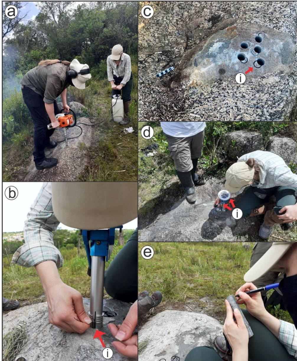
Fig. 4 - Processo de amostragem: (a) perfuração realizada com perfuratriz manual com broca diamantada e sistema de arrefecimento/lubrificação acoplado; (b) marca de referência e processo de marcação com arame de cobre (i); (c) Furos em que foram coletados os cilindros, note que cada furo tem uma marcação rente a ele, que serve como referencial; (d) orientação de furo em que foram obtidas a inclinação, o azimute solar e magnético do furo; (e) transferindo o referencial geográfico para o cilindro após sua orientação.
