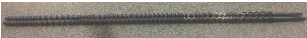
Figura 10. Perfil da rosca utilizada na extrusão em dupla-rosca (Autor, 2021).
