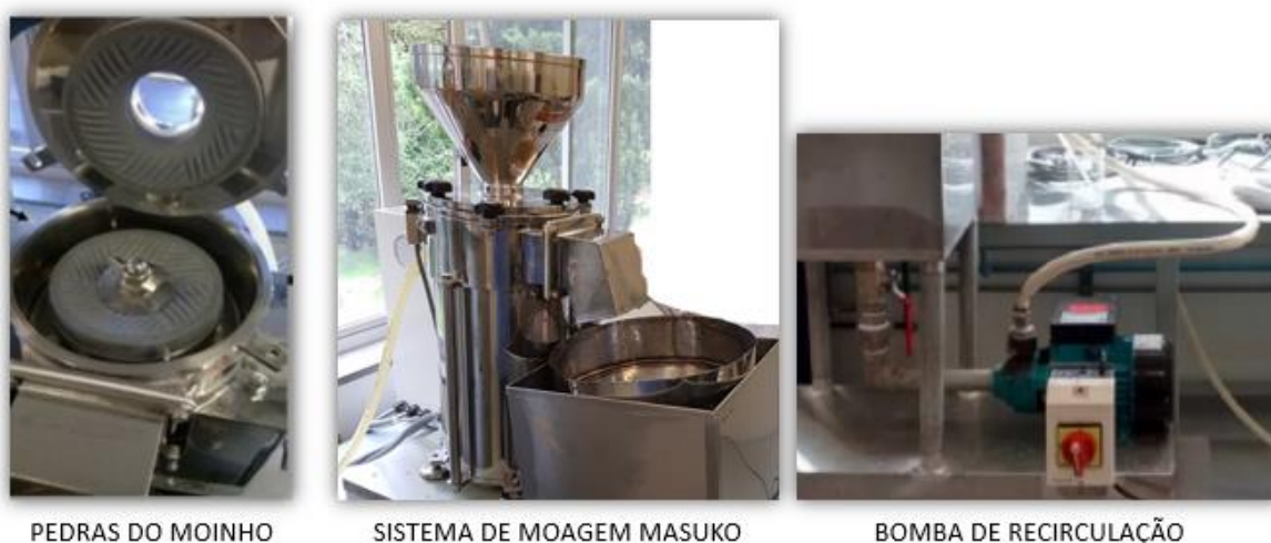
Figura 7. Sistema de moagem com detalhe das pedras de moagem e da bomba de recirculação.
