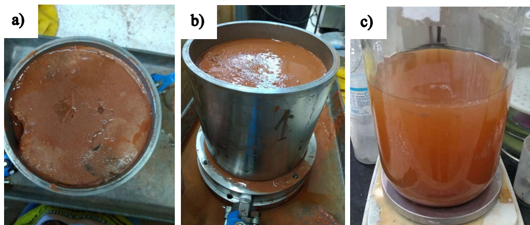
Figura 4.12: Condutividade hidráulica RFVMP (4): a) Ruptura Hidráulica; b) Perda de Volume; c) Líquido Percolado.
