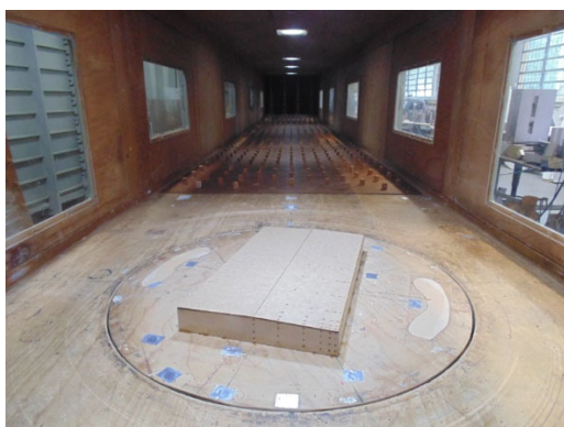
Figura 48 – Mesa giratória II do Túnel de Vento do Prof. Joaquim Blessmann da Universidade Federal do Rio Grande do Sul
