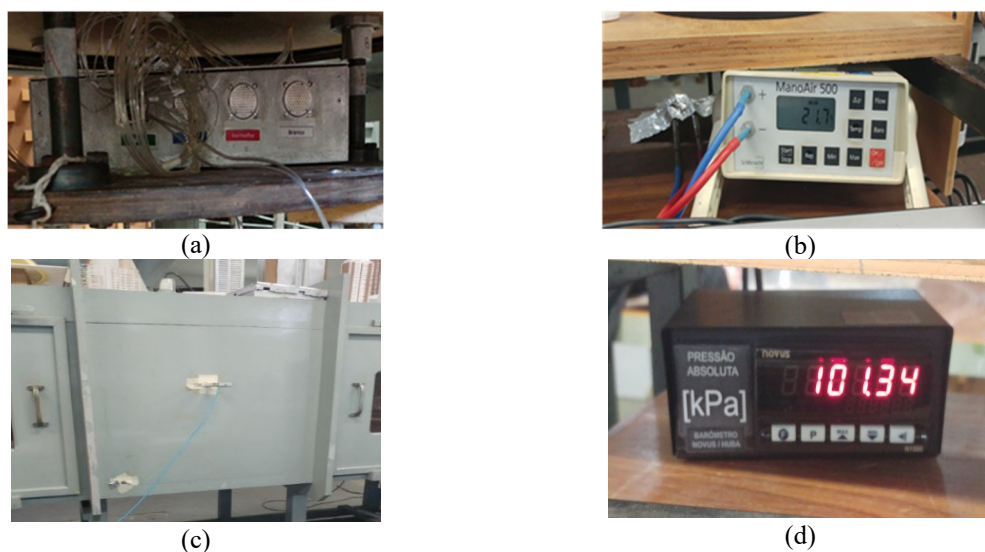
Figura 54 – Instrumentos de aquisição de dados do Túnel de Vento Prof Joaquim Blessmann: (a) Transdutores de pressão; b) Manômetro diferencial digital Manoair ; c) Termômetro digital; d) Barômetro
